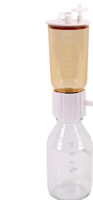
(b). LF 3a / 5a 過濾系統 (連接組織培養瓶)
