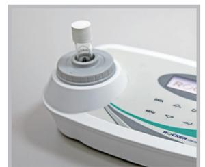
3. 待試劑管冷卻後依序放入檢測儀即可得知 COD 值
