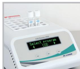
2. 將兩支試劑管放入加熱分解爐做加熱分解
