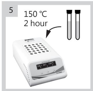
將試劑瓶放到 CR 25 加熱分解爐中並啟動 COD 程式, 以 150°C 加熱 2 小時
